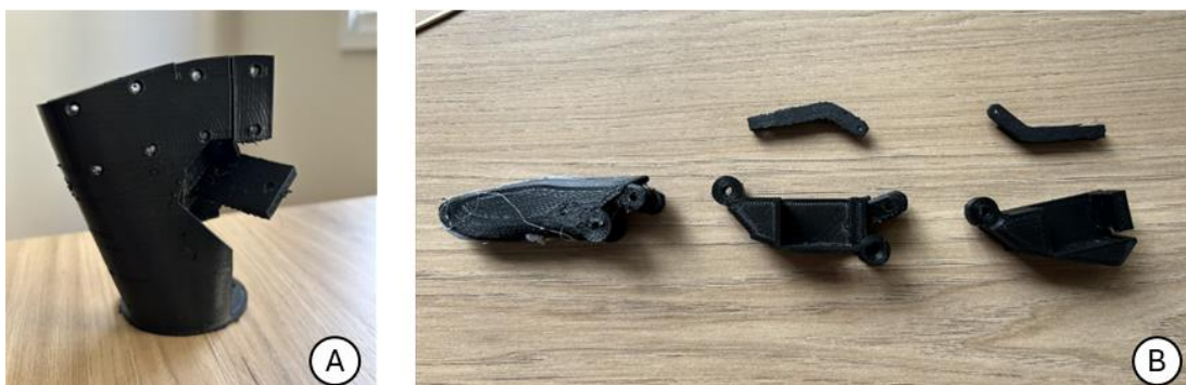
Figura 11: Componentes da prótese - Palma (A), Partes correspondentes à falange distal, proximal e base do dedo (B).
