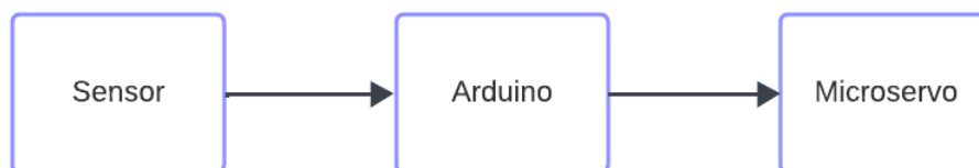
Figura 9: Esquema de blocos do circuito elétrico para controle da prótese.
