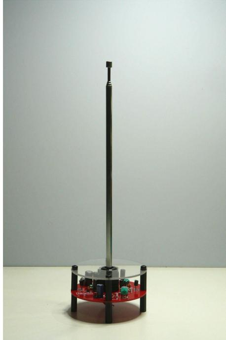
Theremin de uma antena, em modelo desenvolvido por Marcelo Muniz. Uma pequena placa circular de acrílico protege a placa do circuito, também circular.
