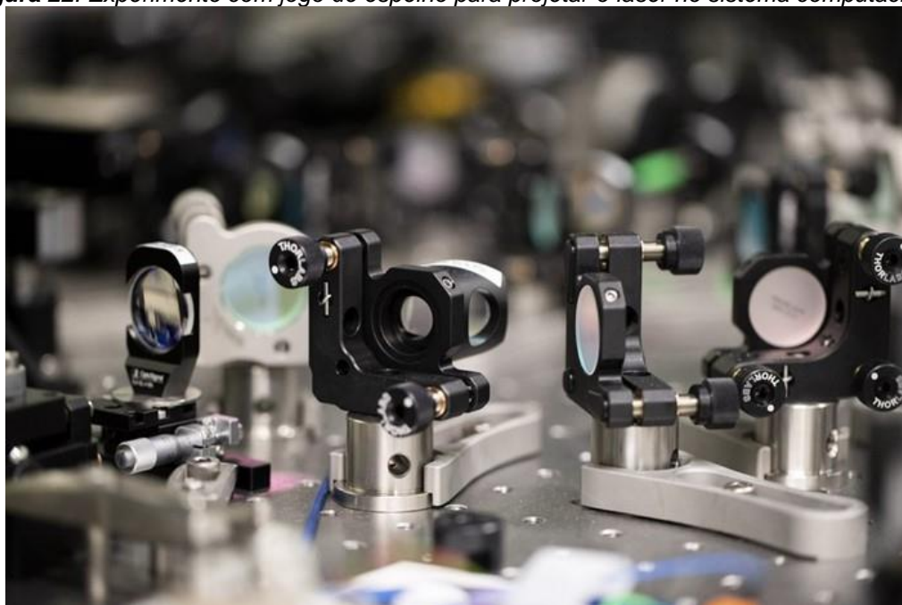
Figura 22: Experimento com jogo de espelho para projetar o laser no sistema computacional
