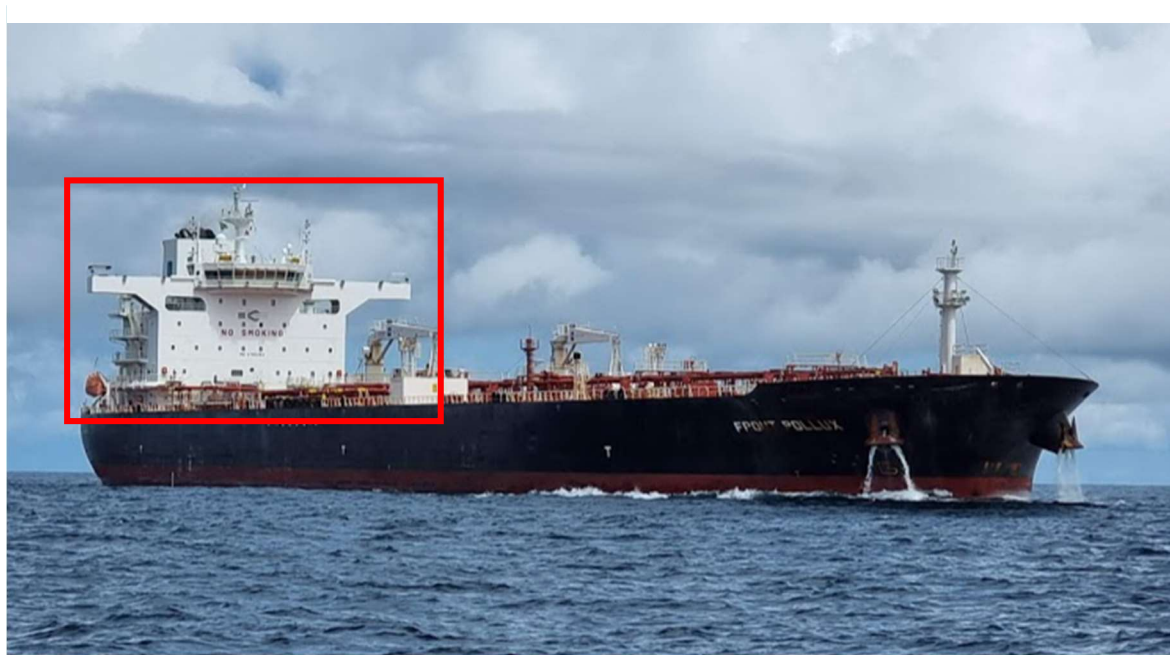
Figura 1 – Superestrutura de um navio petroleiro convencional
