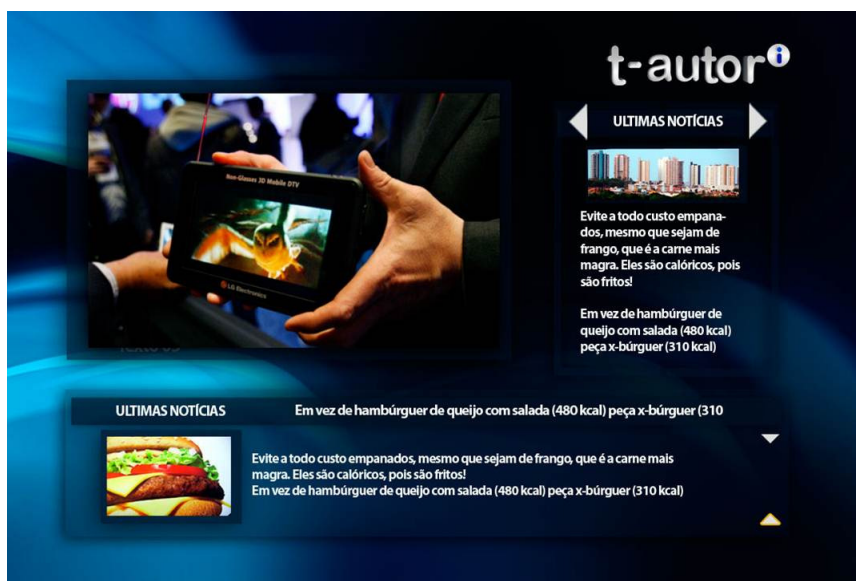
Figura 1 - Exemplo de aplicação de interatividade criada pela solução T-Autor onde a transmissão normal do canal é reduzida na tela e são acrescentados conteúdos adicionais pelos quais o usuário pode navegar
