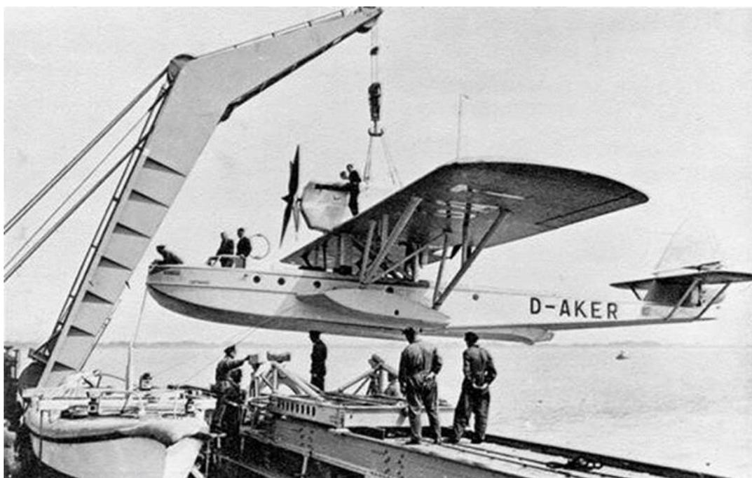
Figura 15 - Aeronave Dornier Wal sendo guinchada para o navio Westfalen.<sup>57</sup>
