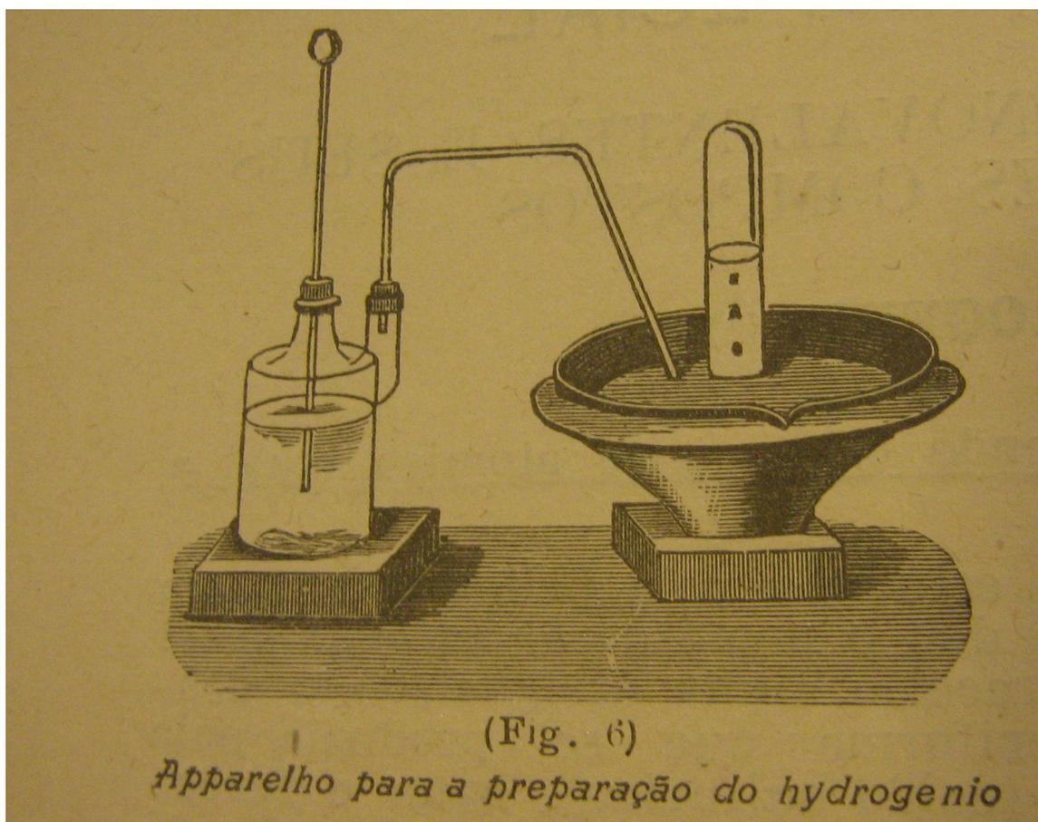
Figura 3: aparelhagem usada para obtenção do Hidrogênio.
