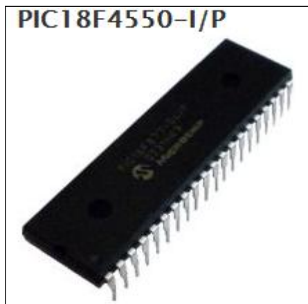
Figura 8 – Imagem do Microprocessador PIC18455-I/P
