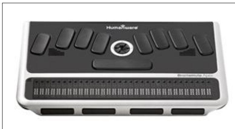
Figura 1 - Display Braille com pinos mecânicos
