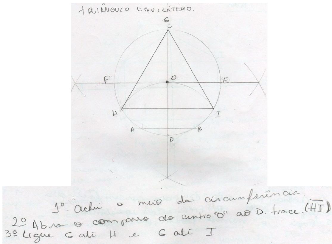
Figura 3.3 – Procedimento utilizado para construção de um triângulo inscrito numa circunferência.
